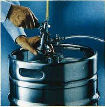
Beim Flach- und Kombifitting den Zapfkopf auf den Anschluss bis zum Anschluss bis zum Anschlag schieben
