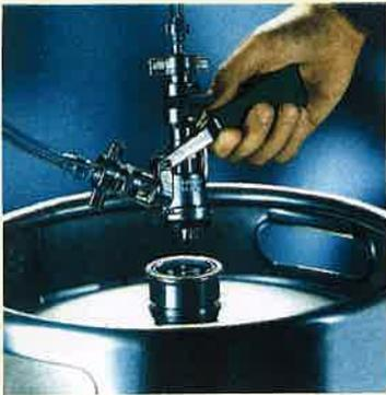
Beim Korbfitting Zapfkopf in den Fitting einsetzen und durch drehen arretieren
